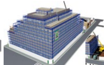
BIMによる検討（外壁組立）
